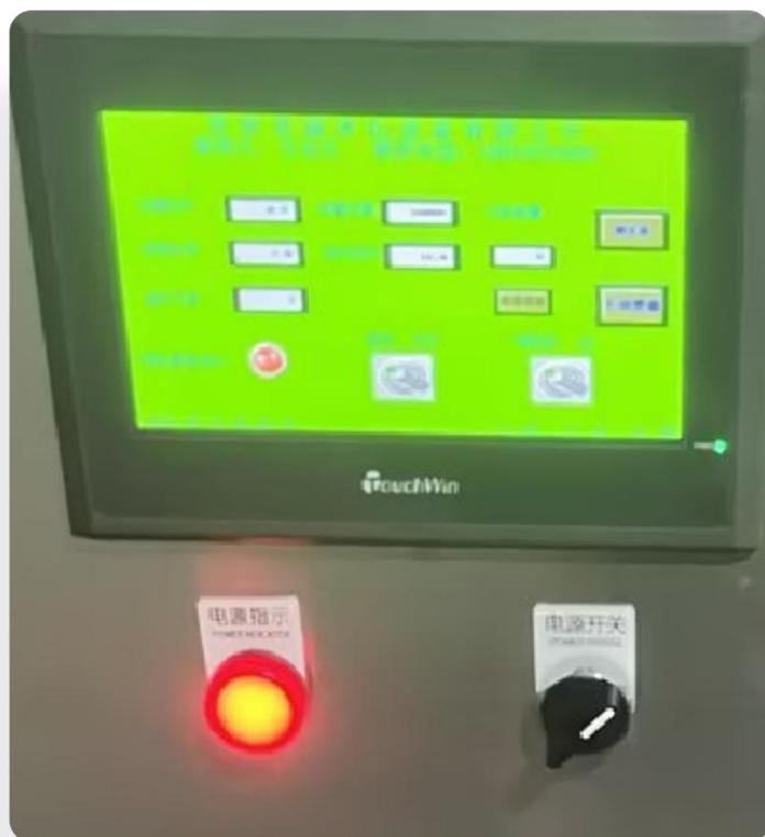
打开控制面板上电源开关，触摸屏灯亮
