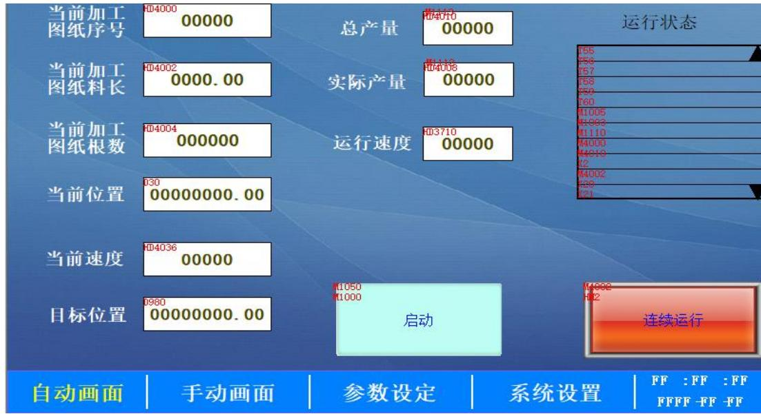
12. 【自动启动】：在系统复位完成后，点击此按钮，系统即可进行自动定长冲切。
